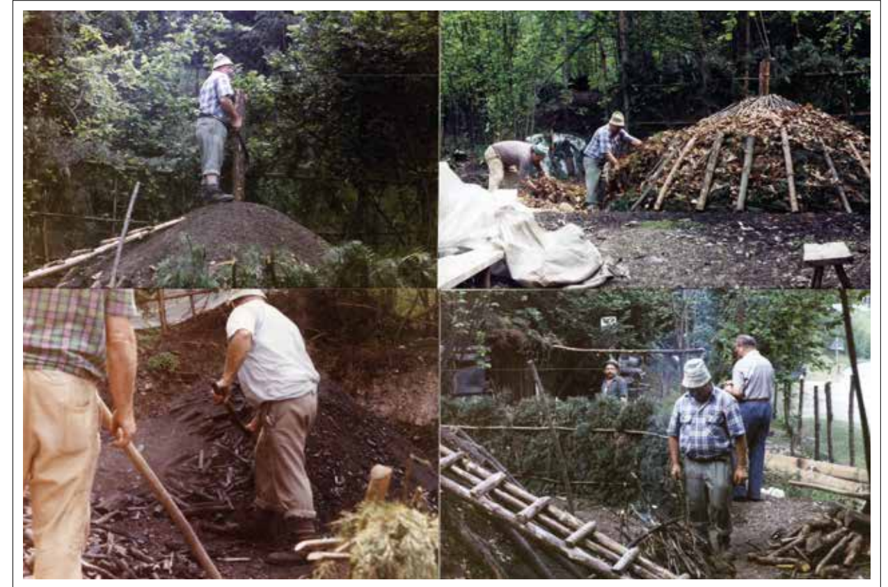
In alto a sinistra stanno togliendo il palo per far partire il POLAT – ANCHE QUI FASE DI COSTRUZIONE E ACCENSIONE Per gentile concessione di Loris Berardinelli, Tignale.
