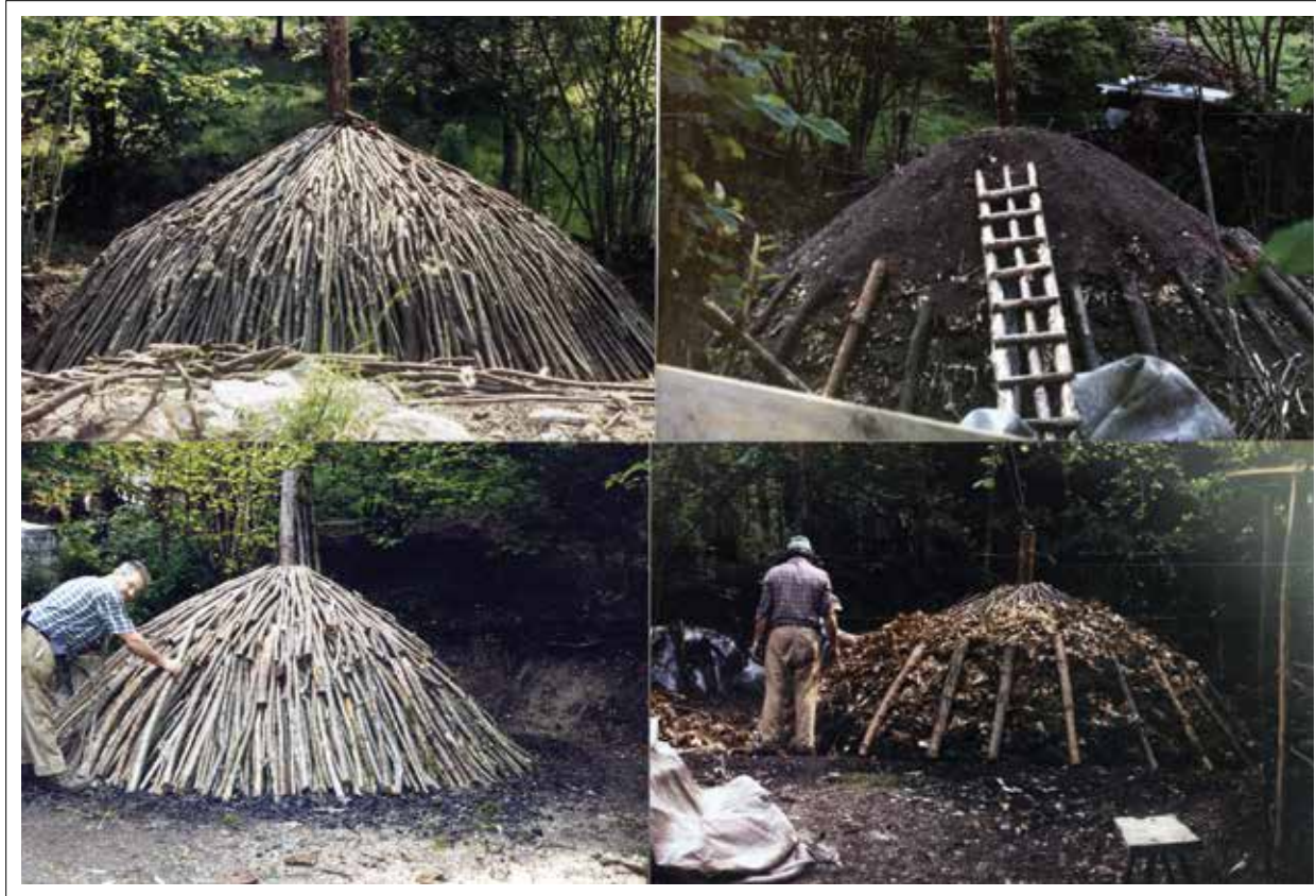
Nella prima foto in alto a sinistra si vede che lo stanno ancora costruendo il POLAT, foto a fianco la costruzione è ancora un po' più indietro mettono i bastoni vicini in piedi e in piano sopra facendo una catasta quasi artistica dove tutti i bastoni sono tutti precisi tagliati della stessa misura Foto in basso si mettono i rami poi le foglie e la terra ricopre tutto per soffocare il fuoco e farlo partire un po' alla volta ci sono delle regole precise per fare il poiat, è un attività complessa e ogni paese aveva il suo stile. In questa serie di immagini si vede anche la scaletta dove salgono per buttare dentro le braci. Per gentile concessione di Loris Berardinelli, Tignale.
