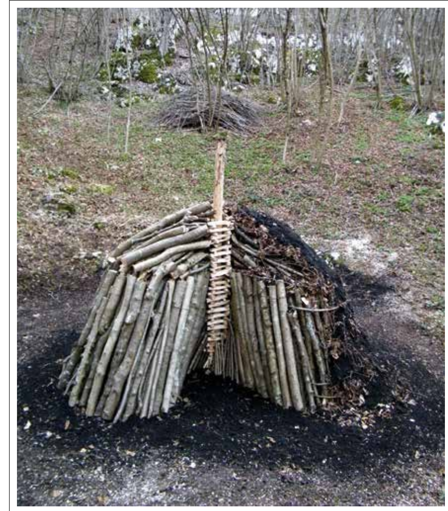
Sezione di un poiato fatto a Serle da Loris Berardinelli- in mezzo si vede il castello, una struttura che sta in piedi da sola quello che ti permette di far stare tutto in piedi quando si toglie il palo centrale, sotto si vedono legnetti piccoli, quando butti giù le bracc prendono fuoco i legnetti piccoli il fuoco va in alto e incominciano a salire le fiamme, quando le fiamme arrivano in alto si cominciano a riempire con legnetti alla fine si tappa tutto con foglie e terra per soffocare un po' e da lì comincia ad uscire il fumo un po' alla volta brucia e continua a bruciare per 2 giorni – dipende dalla grandezza- in Sicilia dura anche un mese. Per gentile concessione di Loris Berardinelli, Tignale.
